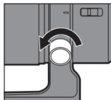
**2** Tournez l'appareil photo et l'objectif pour changer de position.
