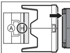
**2 朝箭頭指示的方向轉動鏡頭遮光罩,將鏡頭遮光罩上的標記Ⓑ(○)對準鏡頭頂端的標記。**
