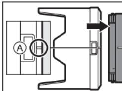
**2 Drehen Sie die Gegenlichtblende in Pfeilrichtung, bis die Markierung (B) (○) an der Gegenlichtblende an der Markierung am Objektivrand ausgerichtet ist.**
